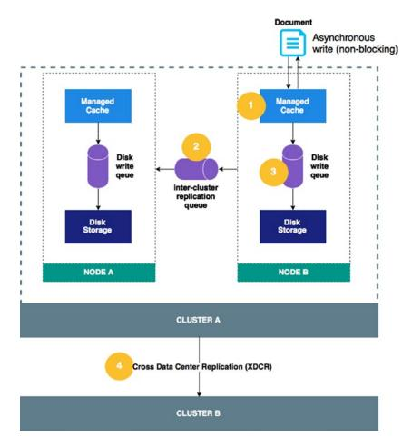
Figure 2-4. Couchbase data flow
