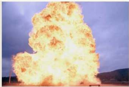
Fireball from propane BLEVE experiment.
